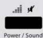
Чтобы включить или выключить звук (звуковой сигнал), в течение трех секунд нажмайте кнопку **Power/Sound** (Мощность/Звук). Сообщения о завершении программ и предупредительные сигналы будут раздаваться и при выключенном звуке.
