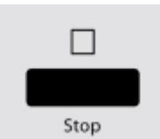
Нажмайте кнопку **Stop (Стоп)** в течение трех секунд, пока не услышите долгий звуковой сигнал и не погаснет индикатор функции. В разблокированном состоянии все кнопки вновь активированы.
