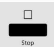
Нажмайте кнопку **Stop (Стоп)** в течение трех секунд, пока не услышите долгий звуковой сигнал и не загорится индикатор функции. В заблокированном состоянии все кнопки дезактивированы.
