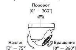
Рисунок 1-15 Настройка угла наблюдения камеры
