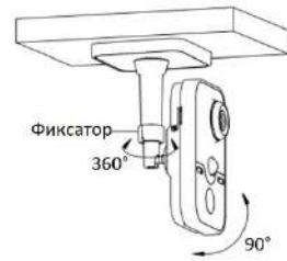
Рисунок 1-25 Настройка угла наблюдения камеры
