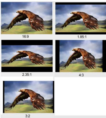
Выберите **Aspect** в качестве значения функции **Scan**, а затем с помощью функции **Aspect** задайте необходимое соотношение сторон. Соотношение сторон выбирается на основании типа входного сигнала.
