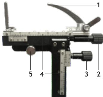
Mechanická stupnice Levenhuk MS3 je určena k přemísťování mikroskopických preparátů na pracovním stolek podél osy X (doleva a doprava) a osy Y (dopředu a dozadu). Dále pomáhá určit souřadnice preparátů. Jednotlivé osy jsou doplněny o pomocnou noniovou stupnici, která slouží k měření s vysokou přesností. Stupnice je vhodná k použití na kovových stolcích. Plastové pracovní stolčky nejsou dostatečně robustní k tomu, aby stupnici udržely, a mohlo by dojít k jejich poškození.
