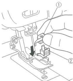
5. Нажмите узел замены нити ① вниз до конца таким образом, чтобы конец ③ узла замены нити попал в ушко верхнего петлителя ④.
