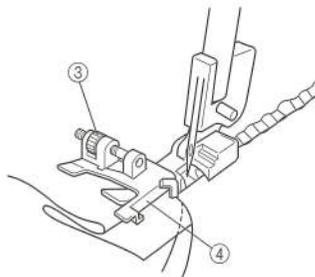
③ Винт регулировки
