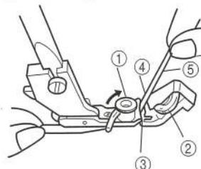
1. Установите лапку для пришивания тесьмы (см. ГЛАВУ 1 “Установка и снятие прижимной лапки”).
