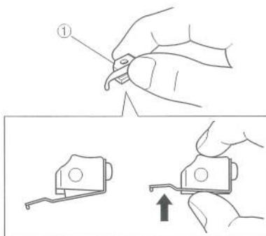
4. Удерживая узел замены нити ①, введите в отверстие узла замены нити верхний конец вала OL ② таким образом, чтобы вал OL прошел через отверстие.
