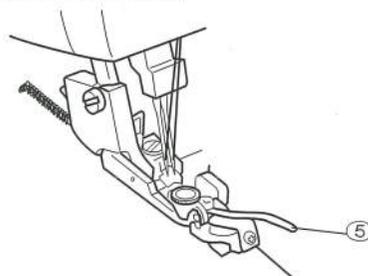
1. Поднимите рычаг прижимной лапки.
