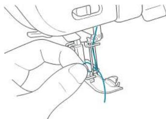
7. Поднимите рычаг прижимной лапки ①, пропустите конец нити через прижимную лапку, а затем вытяните примерно 5 см нити задней части машины.
