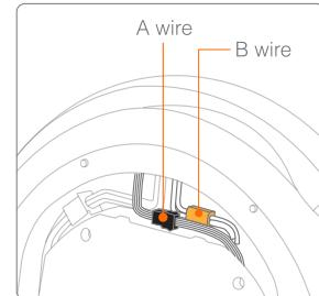
Выключите питание моноколеса. Откройте резиновую мягкую заглушку на левой стороне корпуса устройства (как показано на рисунке, выше подножки) и открутите оба винта при помощи крестовой отвертки.
