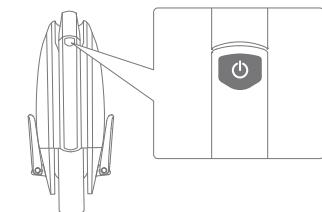
3 Нажмите кнопку «Поиск устройства», чтобы связать приложение с моноколесом. При удачном соединении, вы услышите звуковой сигнал. После этого мобильное приложение отобразит значок подключения и информацию о моноколесе. После удачного соединения, следуйте инструкции в приложении.
